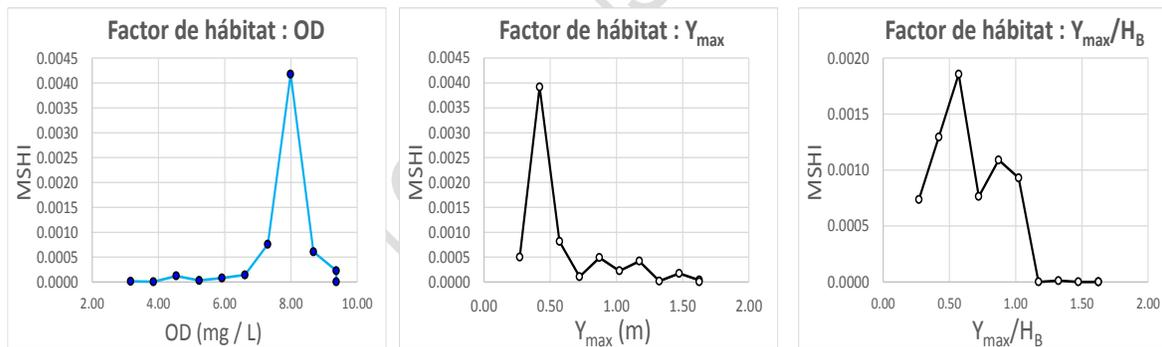
**Figura 39** Índice MSHI para diferentes factores de hábitat (oxígeno disuelto, profundidad máxima y profundidad de banca llena). Fuente: Minambiente-CORNARE (2015).
