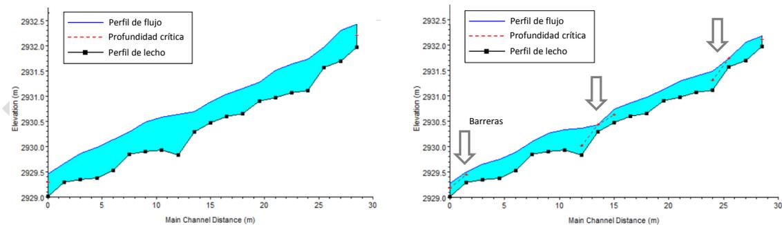
(a) Condición hidrológica por encima de caudal  $Q_{t-Q}$ . Flujo subcrítico a lo largo del segmento
