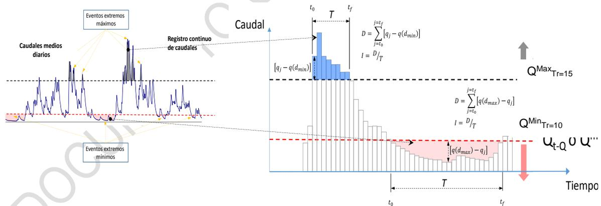
**Figura 62** Esquematzación de eventos extremos de interés hidrológico y ecológico (excesos y déficits) y caracterización de sus atributos. Fuente: Minambiente-CORNARE (2015).
