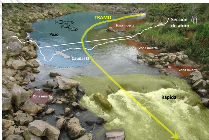
**Figura 57** Esquematización del levantamiento integrado de información hidrométrica, fisicoquímica e hidrobiológica en inmediaciones de sitios de monitoreo establecidos. Fuente: Minambiente-CORNARE, 2015.
