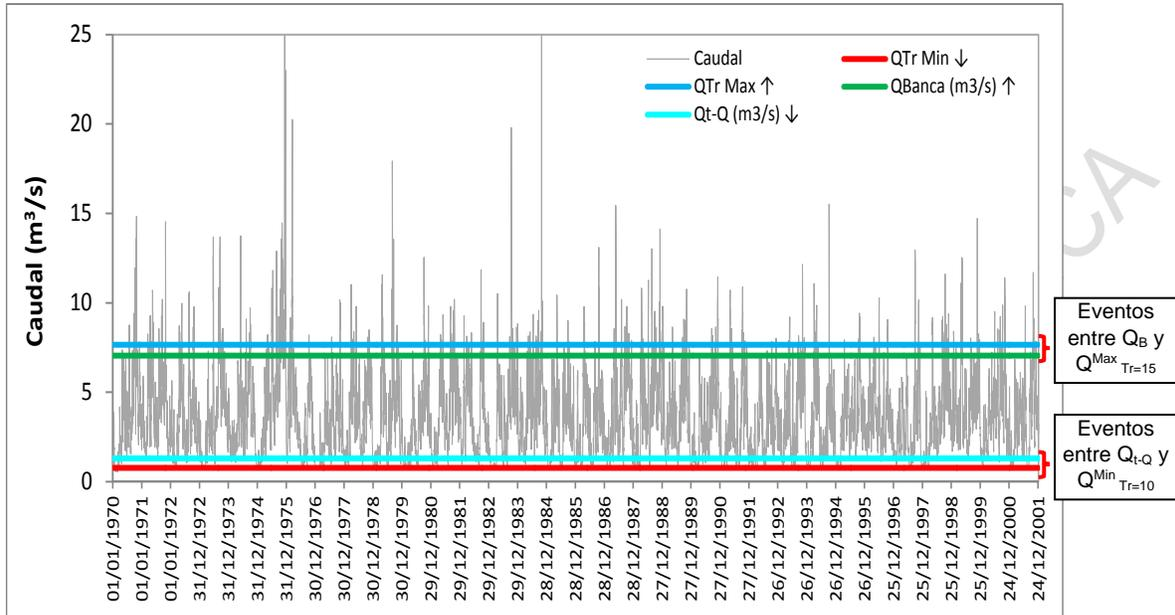
**Figura 60** Visualización de serie de tiempo de caudales y métricas definidas por los componentes ambientales del régimen  $Q_{t-Q}$  y  $Q_B$ ,  $Q_{\max Tr=15}$  y  $Q_{\min Tr=10}$ . Fuente: Minambiente-CORNARE (2015).
