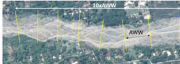
(a) Río trenzado y esquematización de la longitud mínima y nivel de detalle para una adecuada caracterización morfológica
