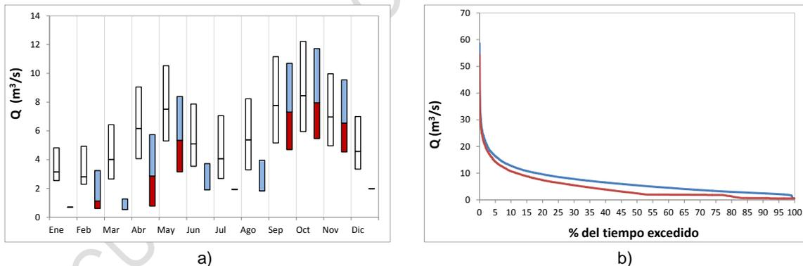
**Figura 34** Régimen de caudales en condiciones naturales y alteradas: (a) Régimen de caudales medios en condición natural (cajas blancas) y luego del aprovechamiento máximos considerando el régimen de los componentes del régimen QB↑; QTr=15↑; Qt-Q↓; QTr=10↓; (b) Curvas de duración en condición natural (azul) y luego del aprovechamiento máximos considerando el régimen de los componentes del régimen. Fuente: Minambiente-CORNARE (2015).
