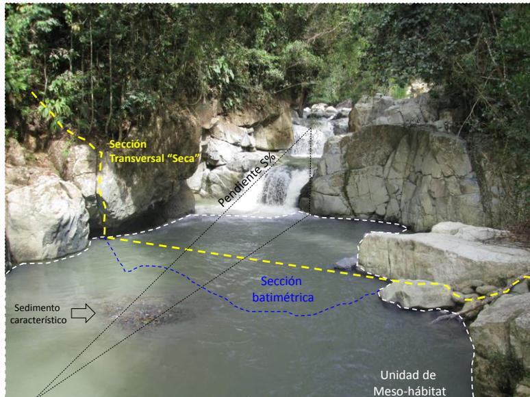
**Figura 12** Esquematación de sección transversal seca y batimétrica en el sitio de monitoreo.
