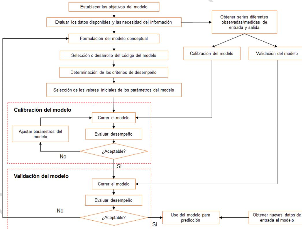
Figura 20 Protocolo de modelación hidrológica. Adaptado de Dingman (2002).
