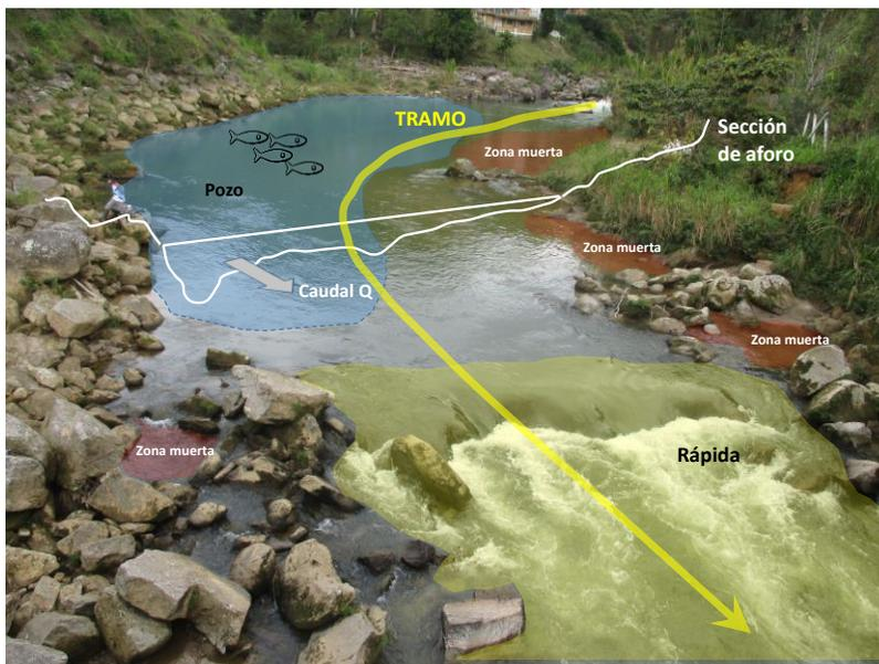
**Figura 18** Esquematación del levantamiento integrado de información hidrométrica, fisicoquímica e hidrobiológica en inmediaciones de sitios de monitoreo establecidos. Fuente: Minambiente-CORNARE (2015).
