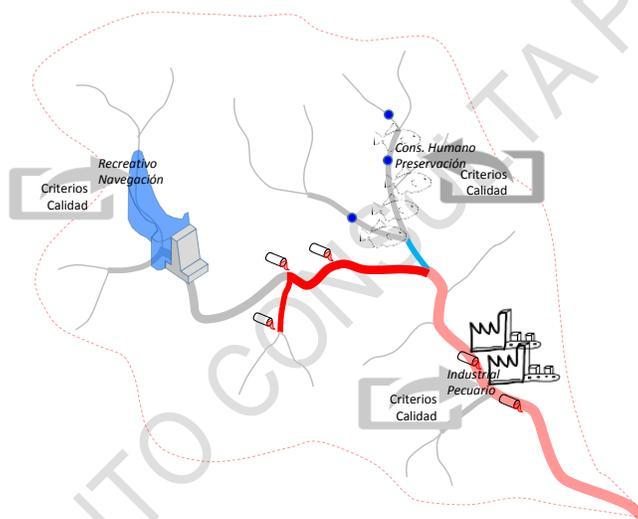
**Figura 64** Esquematación de la consideración de criterios de calidad de agua, de acuerdo con los usos del agua que se identifiquen a partir de la información secundaria y la información hidrobiológica en sitios de monitoreo. Fuente: Minambiente-CORNARE (2015).
