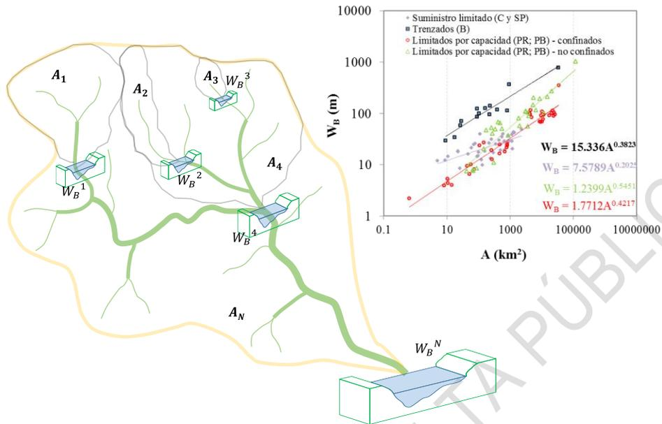
**Figura 28** Esquematación de la geometría hidráulica hacia aguas abajo para el ancho de banca llena. Fuente: Minambiente-CORNARE (2015).
