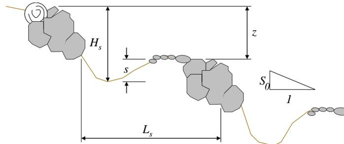
**Figura 14** Localización recomendada de secciones transversales en sistemas escalón-pozo, o sistemas transicionales rápidas-pozo.  $H_s$  representa la altura de la caída,  $L_s$  la separación cresta a cresta,  $z$  la caída entre crestas y  $s$  la profundidad de socavación en el pozo.
