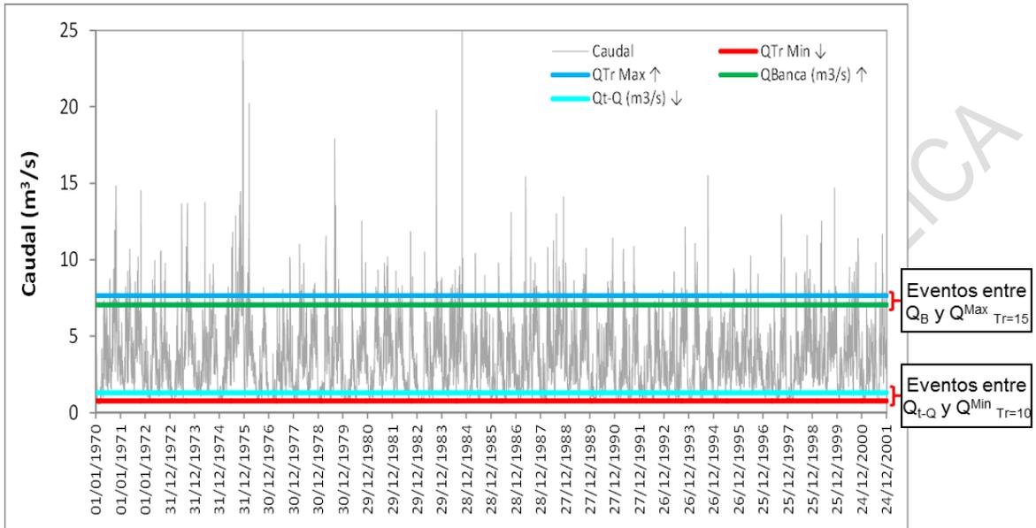
**Figura 31** Visualización de serie de tiempo de caudales y métricas definidas por los componentes ambientales del régimen  $Q_{t-Q}$  y  $Q_B$ ,  $Q_{maxTr=15}$  y  $Q_{minTr=10}$ . Fuente: Minambiente-CORNARE (2015).
