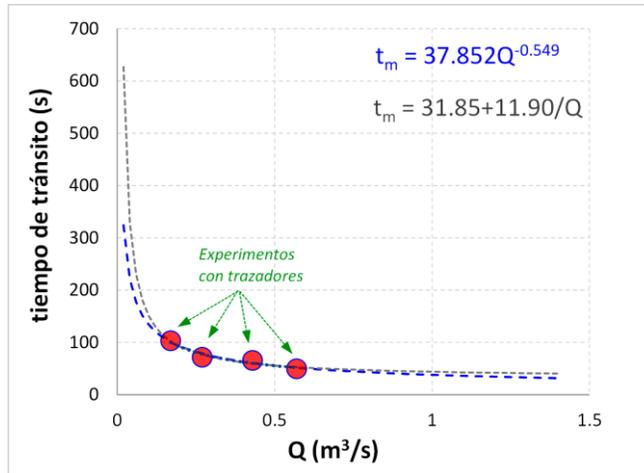
**Figura 23** Aproximación al diagrama t-Q empleando experimentos con trazadores.
