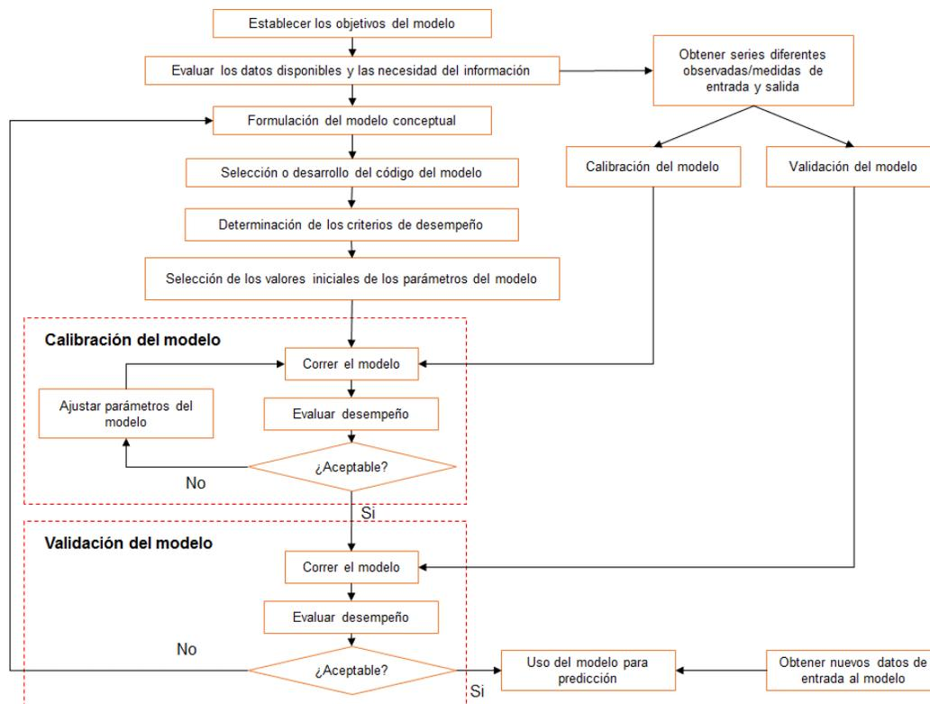
Figura 58 Protocolo de modelación hidrológica. Adaptado de Dingman (2002).
