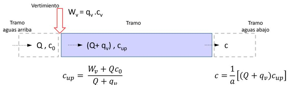
**Figura 41** Esquematación de la aplicación del factor de asimilación en la escala de tramo.
