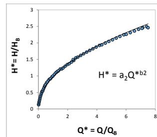
**Figura 29** Esquematación de la geometría hidráulica en la estación para el ancho de banca llena. Fuente: Minambiente-CORNARE (2015).
