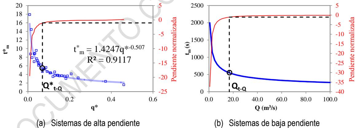
**Figura 24** Identificación de métrica  $Q_{t-Q}$  a partir diagramas tiempo caudal: en sistemas de alta pendiente según Jiménez y Wohl (2013) y en sistemas de planicie de acuerdo con el modelo MDLC (Camacho y Lees, 1999).
